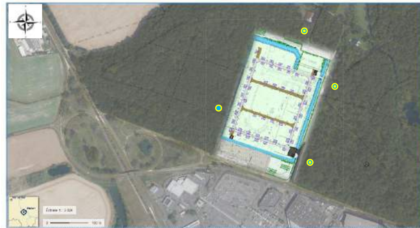
Figure 12 – Implantation du réseau de piézomètres
