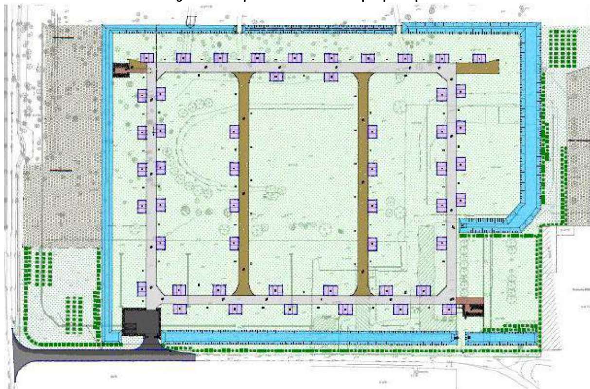
Figure 10 – Implantation de la noue périphérique
